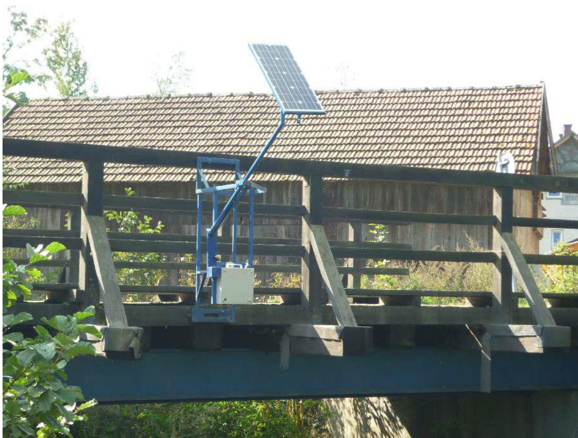
Fot. 34. Przykładowa stacja do pomiaru poziomu wody w cieku wodnym
