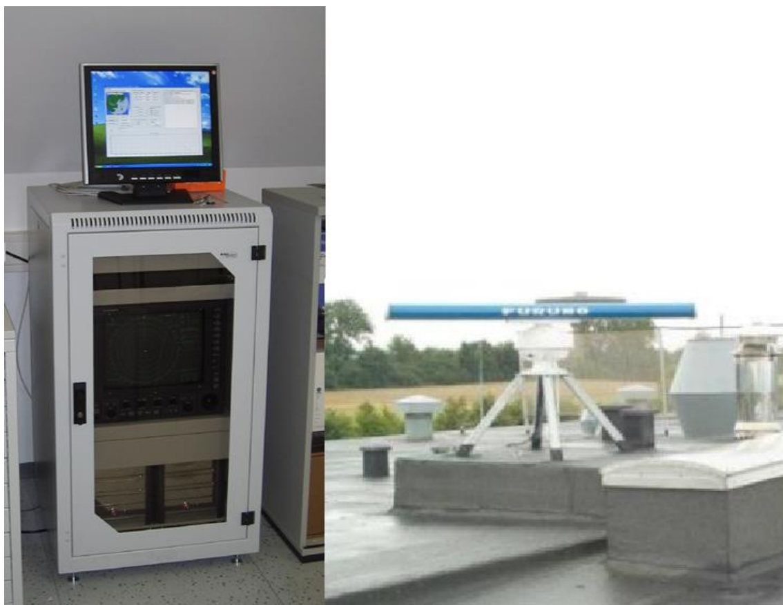
Fot. 33. Radar pogodowy DHI – LAWR oraz szafka sterownicza wraz z komputerem PC.
